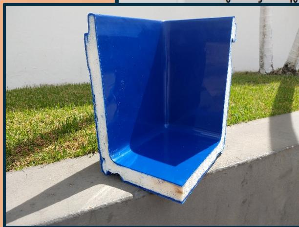
Resultado: os testes para ajustes de produção com peças utilizando polietileno expansivo necessitam de um severo e preciso ajuste de temperatura, só possível com uso do ROTOMAXI
